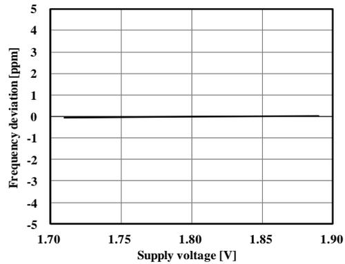
7060EAV,  $f_{OUT}=155.52\text{MHz}$ ,  $T_a=25^\circ\text{C}$ , 1.8V std.
