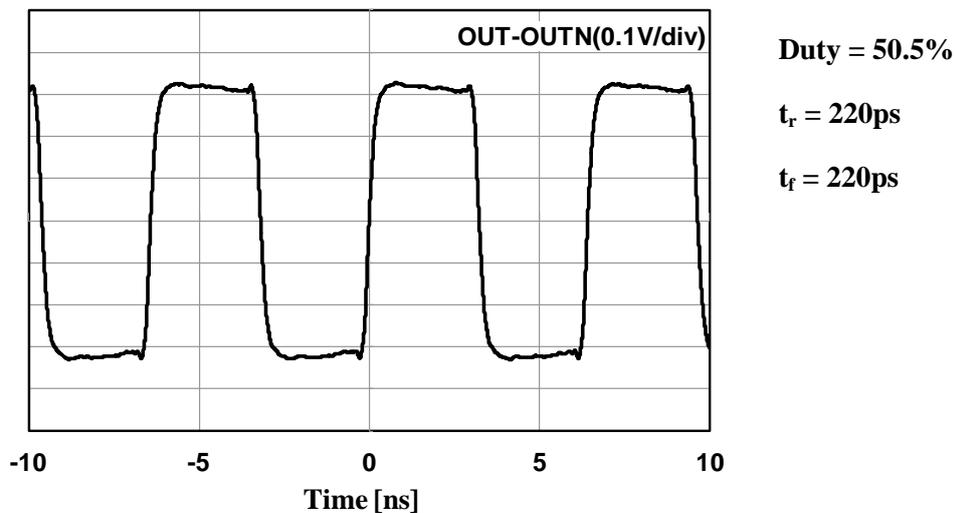
7060EAV,  $f_{\text{OUT}}=155.52\text{MHz}$ ,  $V_{\text{DD}}=1.8\text{V}$ ,  $T_a=25^\circ\text{C}$
