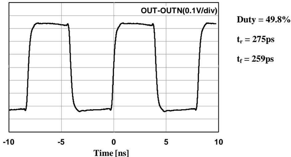
7060DAV,  $f_{\text{OUT}}=122\text{MHz}$ ,  $V_{\text{DD}}=1.8\text{V}$ ,  $T_a=25^\circ\text{C}$
