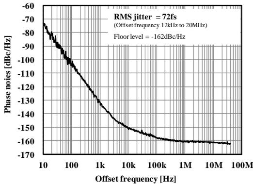
7060DAV,  $f_{OUT}=122\text{MHz}$ ,  $V_{DD}=1.8\text{V}$ ,  $T_a=25^\circ\text{C}$
