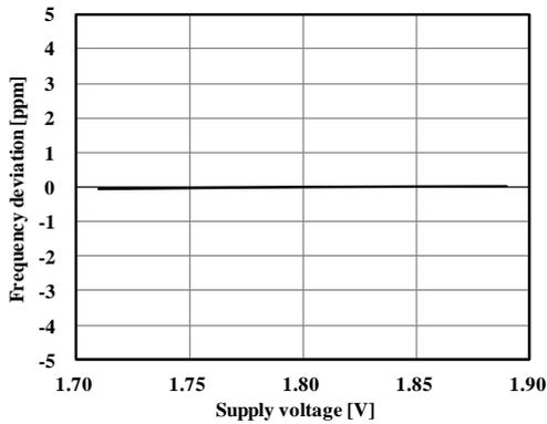
7060DAV,  $f_{OUT}=122\text{MHz}$ ,  $T_a=25^\circ\text{C}$ , 1.8V std.
