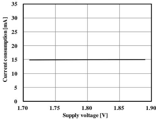
7060DAV,  $f_{OUT}=122\text{MHz}$ ,  $T_a=25^\circ\text{C}$
